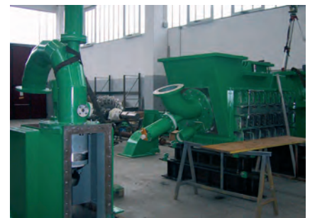
Premontaggio di turbina Pelton. Preassembly of a Pelton turbine.
